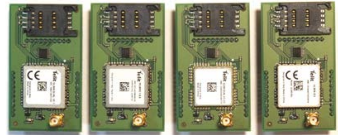
Мезонины с разными GSM-модемами (2G/3G/4G)
