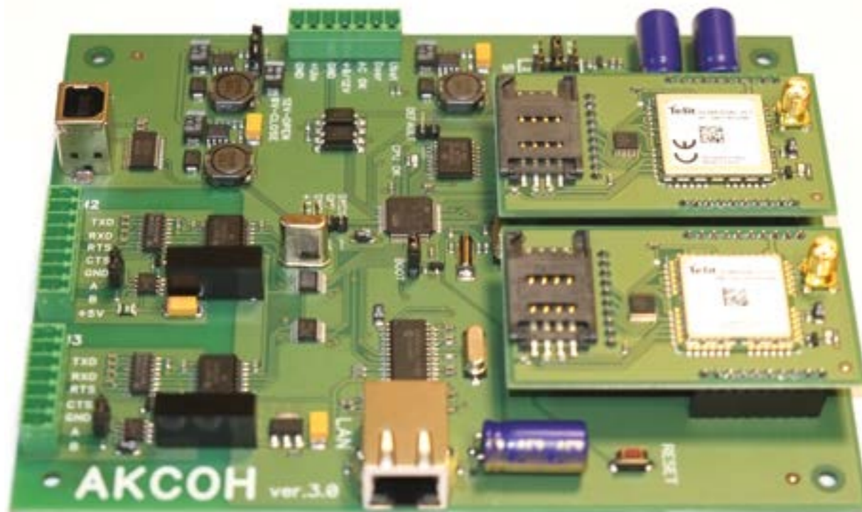
Плата контроллера «Аксон-XL» (основная) с установленными мезонинными модулями
